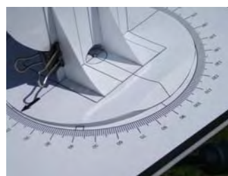
図3 ソリが出たので折り曲げて水平垂直に補正
